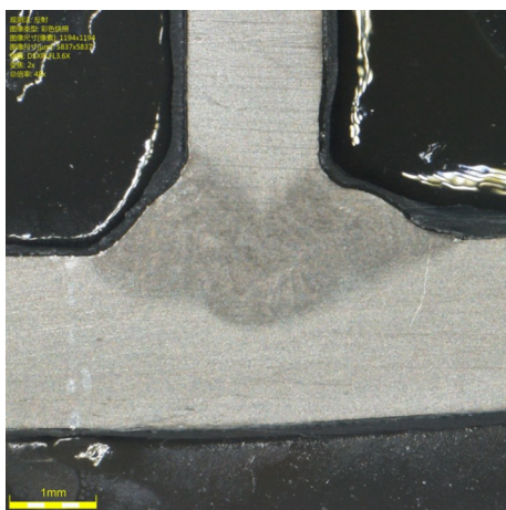
图3 TC4 钛合金焊缝接头形貌
